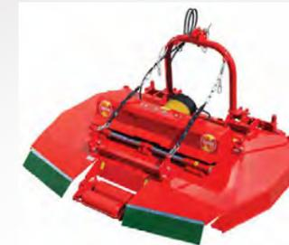
Humus Kreiselmulcher LV mit hydraulisch verstellbarer Arbeitsbreite
