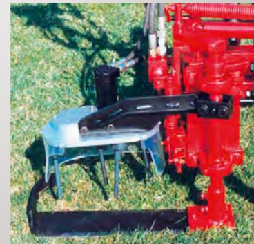
Fuhrmann-Unkrautkreisel trennt durch rotierende Stäbe Unkraut und Erdrich, welches durch das Schwert des Zwischenstockräumgerätes angehoben wird.
