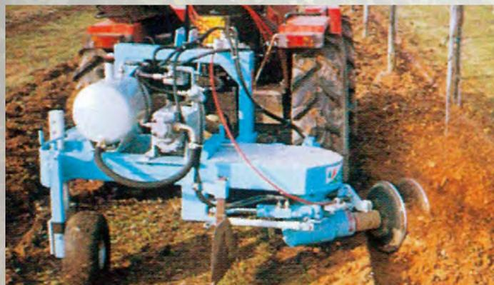
Universelles **Scheiben-Stockräumgerät**, das in wenigen Minuten als **Reihenmulcher**, **Zwischenstockräumgerät** oder **Zwischenstockfräse** umgerüstet werden kann.
