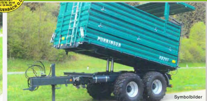
Tandem Dreiseitenkipper von 10 bis 20 Tonnen
