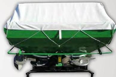
1.200 l, 2 hydraulische Schieber, hydr. Limiter (Grenzstreueinrichtung),
