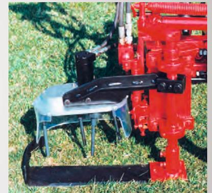
Der Unkrautkreisel trennt durch rotierende Stäbe Unkraut und Erdrich, welches durch das Schwert des Zwischenstockräumgerätes angehoben wird.
