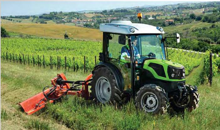
Die neue Serie 3 mit ausgereifter DEUTZ-FAHR-Technologie kommt mit drei Modellen daher – 3050 Narrow, 3050 und 3060 – die allesamt mit einem leistungsstarken Common-Rail-Motor mit elektronisch gesteuerter Einspritzung der Abgasklasse Stage V ausgestattet sind. Die Traktoren der Serie 3 überzeugen durch ihr ausgewogenes Gewicht-/Leistungs-Verhältnis, das zu den besten in dieser Kategorie zählt. Die kleinen
