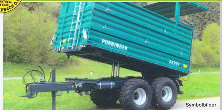
Tandem Dreiseitenkipper von 10 bis 20 Tonnen
