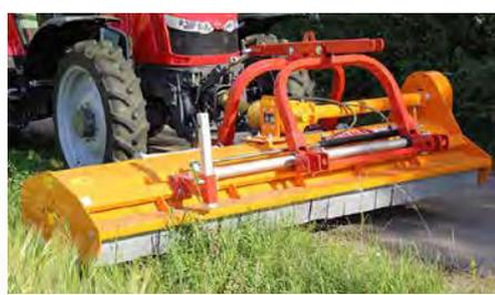
Hydraulisch verschiebbarer Schlegelmulcher für Front- u. Heckanbau bis 3 m Arbeitsbreite.
