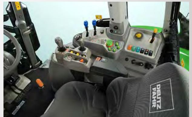
Das RV Shift-Getriebe wurde auf der EIMA als „Technische Innovation 2022“ ausgezeichnet. Geschaltet wird einfach über den Joystick, ohne Zugkraftunterbrechung von 1,5 bis 50 km/h.
