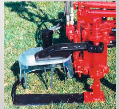
Fuhrmann-Unkrautkreisel trennt durch rotierende Stäbe Unkraut und Erdrich, welches durch das Schwert des Zwischenstockräumgerätes angehoben wird.
